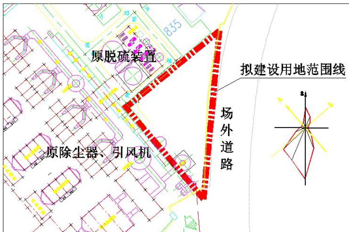
图 2-3 新建脱硫系统建设位置
